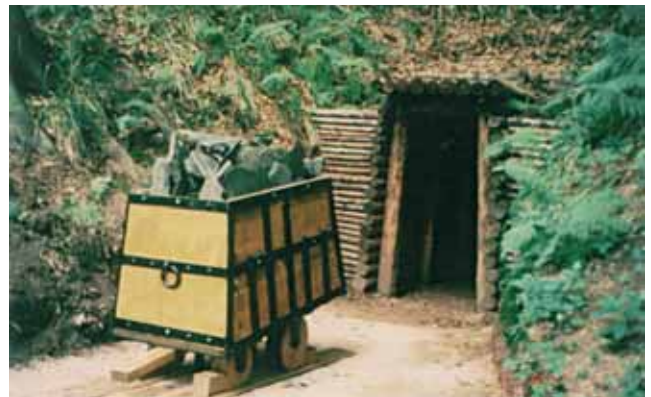
Eingang des Fürstenstollens mit davor stehendem Hunt (Karren)
