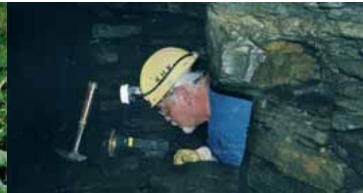
Die geringe Mächtigkeit des Kupferschieferflözes von 40 – 60 cm bedingte eine extrem niedrige Arbeitshöhe. Der Abbau erfolgte im Liegen.
